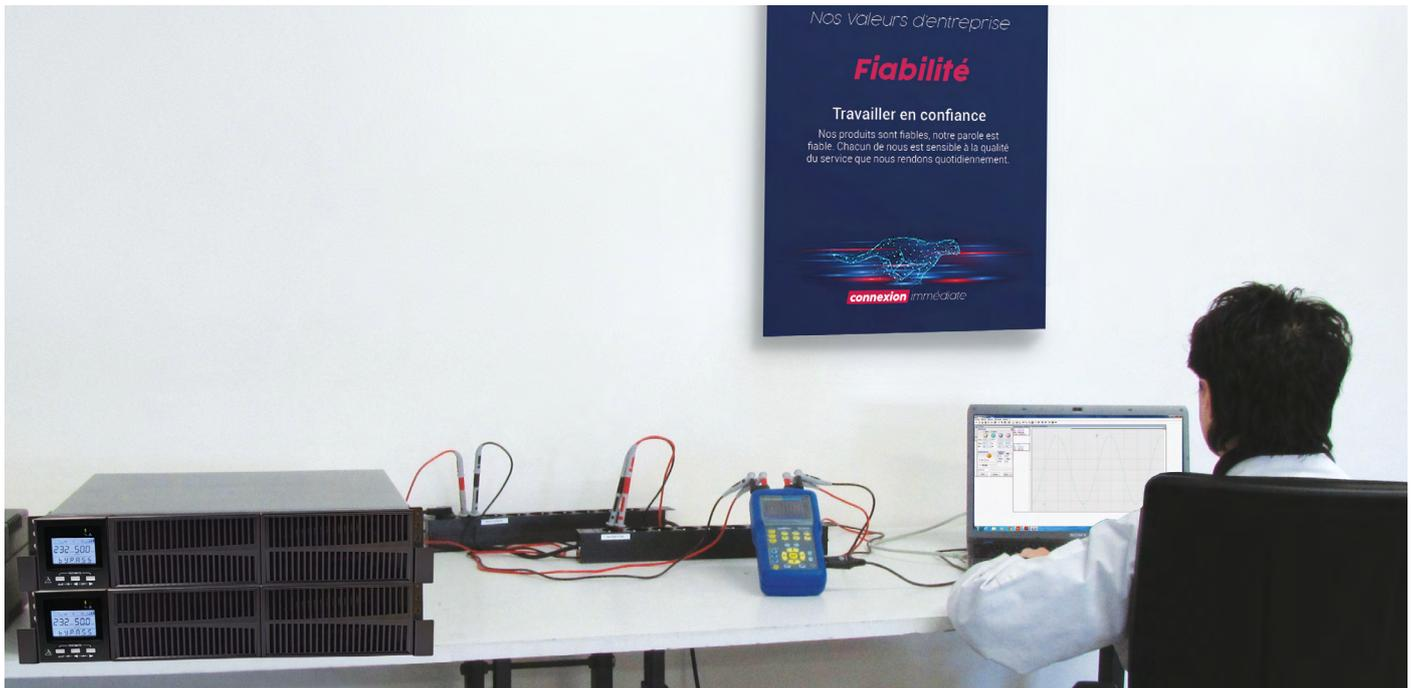
Tout au long de la fabrication, nos onduleurs sont soumis aux contrôles les plus sévères.
